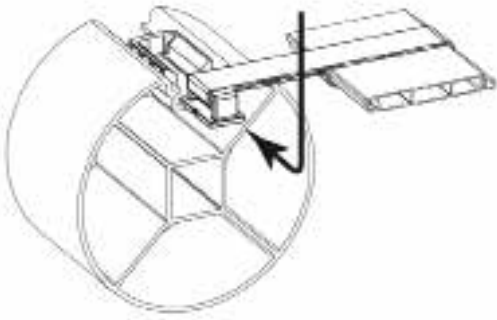
Abbildung 45 – Verbindung von Rollabdeckung und Achse
