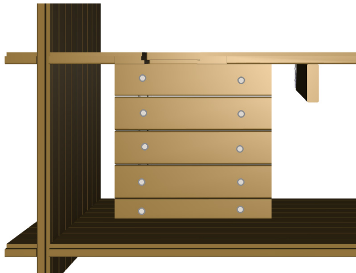
Abbildung 15 – Montage des Box-Bodens
