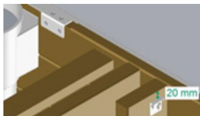
Abbildung 35 – Positionierung des Verschlussblechaufsatzes
