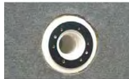
Düse ohne und mit Gummidichtung
