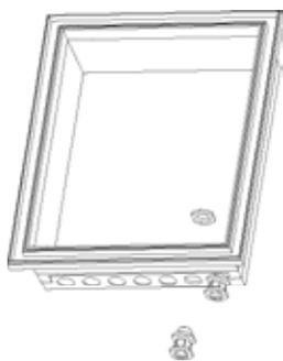
Die Tür des Schaltkastens ist reversibel. Um die Tür umzudrehen, müssen Sie zuerst die Tür, Scharniere und Schloss entfernen und diese dann seitenverkehrt wieder einsetzen und die Tür einrasten.
