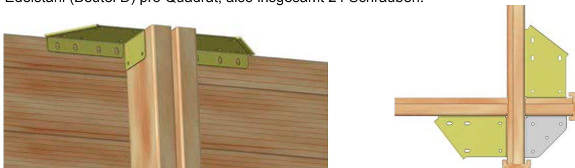
Abbildung 13 – Platzierung der Handlaufeckwinkel auf den Streben und in den Ecken
