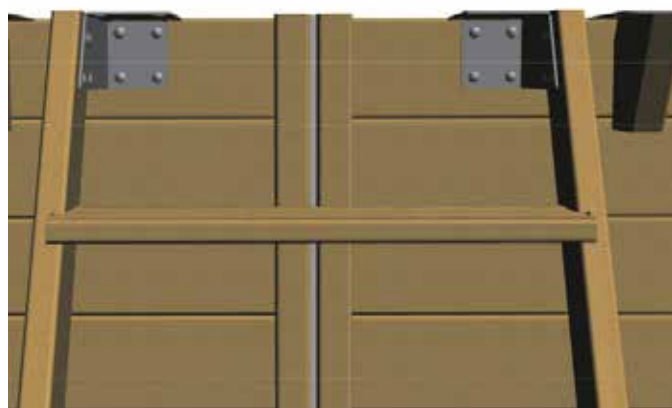
Anbringen der Außentreppe am Becken
