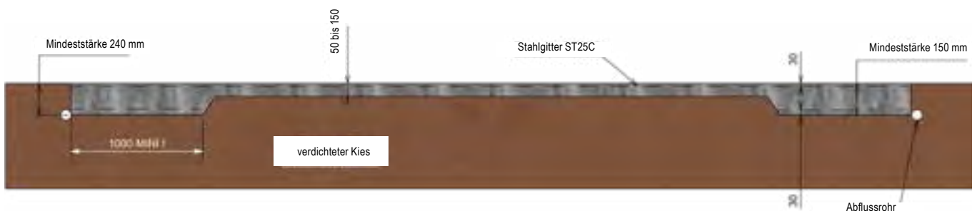
Abbildung 1 – Grenze des Aushubs und Abmessungen der Betonplatte
