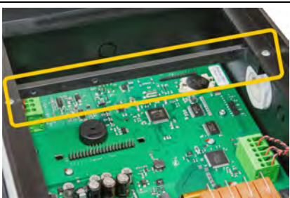
Drücken Sie die Montage-Schiene ② auf die Gewindeeinsätze im Pool Relax Gehäuse
