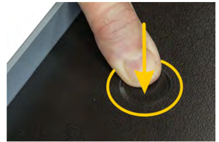
Drücken Sie den Push-Out abwechselnd kräftig nach oben und unten, bis Sie ihn komplett herausdrücken können
