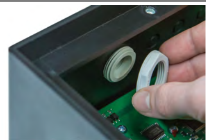
Befestigen Sie die Kabelverschraubung mit der zugehörigen Mutter ⑥
