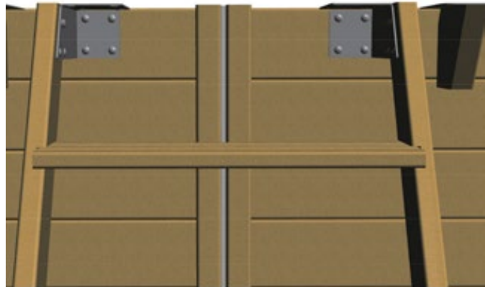
Abbildung 17 – Anbringen der Außenterrasse am Becken
