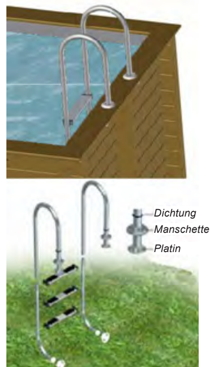
Abbildung 36 – Montage de l'échelle
